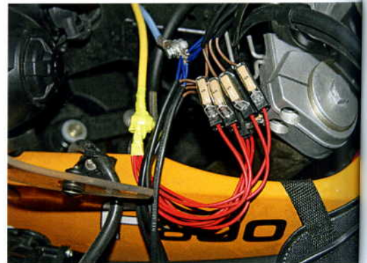
Sicher warm bleiben: Die beheizte Kleidung von Klan ist einzeln verkabelt und abgesichert
